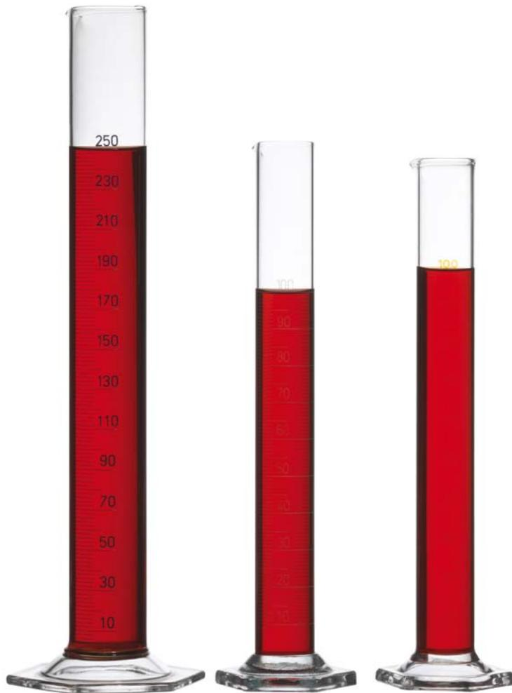
*Las probetas tienen distintos tamaños, pero todas tienen una base ancha para prevenir que se vuelquen.*
